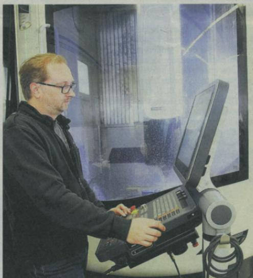
Immer wieder wird in moderne Technik investiert: Andreas Sommer an der Fünf-Achsen-CNC-Fräsmaschine.
